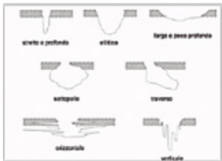
Immagine 4. Forme di corrosione sugli strumenti
