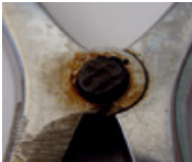
Immagine 9. Parti di ricambio non conformi (vite)
