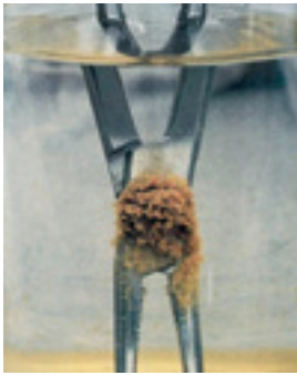
Immagine 7. Immersione in soluzione corrosiva
